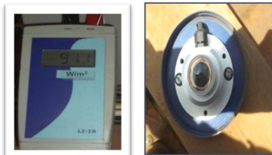
Fig.3.a. Enregistreur Fig.3.b. Capteur du type LP02
